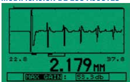
Visualización simultánea de la lectura del espesor y de la forma de onda en el modo opcional A-scan
