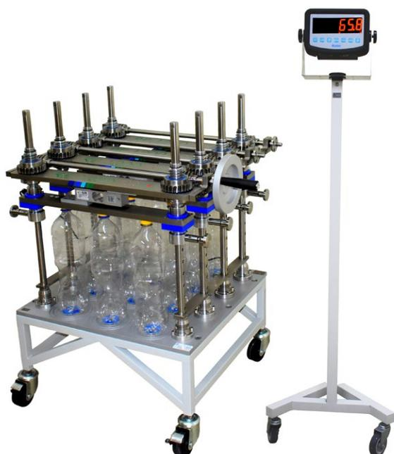
El dispositivo para prueba de resistencia a la estiba, permite someter los envases a cargas conocidas, simulando el efecto de la estiba en los almacenes de producto y así verificar el comportamiento de la tapa, el liner y la boca de la botella.
